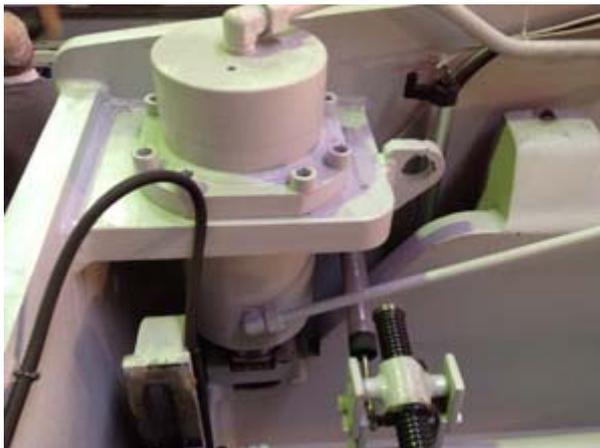
Угол наклона лезвия может быть установлен с минимальным значением 0,7 градуса, что позволяет резать узкие полосы с минимальным искажением, уменьшая, или полностью исключая, эффекты штопора и сабли.
